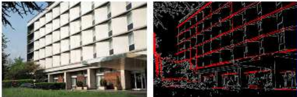
7.5. ábra. Vonallétesítés Hough transzformációval
