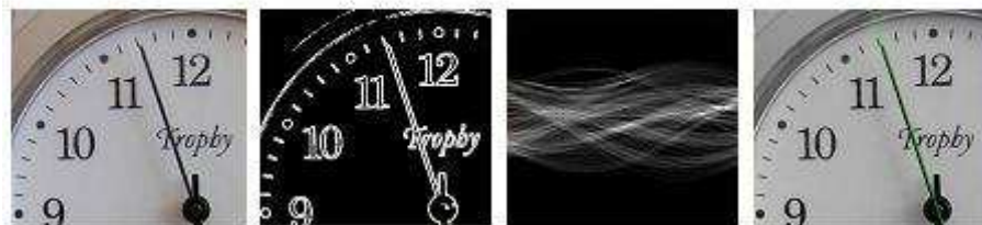
7.6. ábra. Vonallétesítés Hough transzformációval. Eredeti kép - éldetektált kép - Hough tér - legjobb egyenes.
