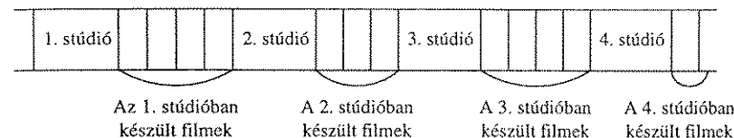
4.16. ábra. Egy nyalábolt fájl, amelyben mindegyik stúdió össze van nyalábolva az általa készített filmekkel
