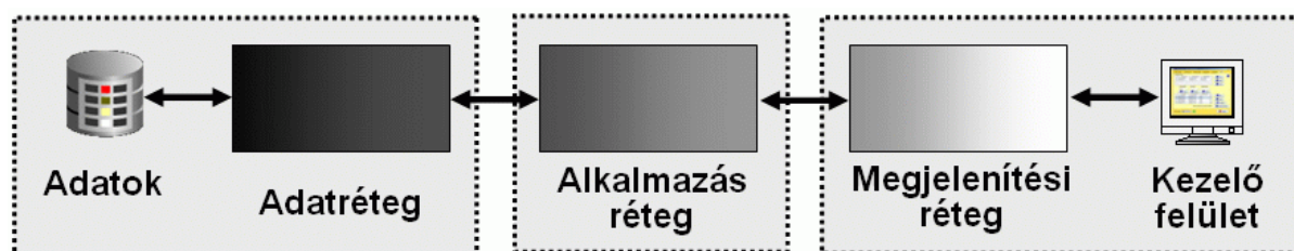
1.3. ábra: Háromrétegű struktúra komponensei (KEP_A303_I_01_03) KEP_A303_I_01_03.JPG
