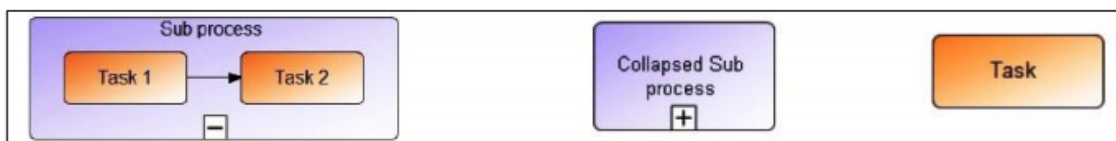
104. ábra Kibontott részfolyamat, összevont folyamat (collapsed subprocess) és feladat (task)
