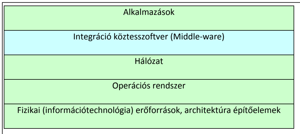
76. ábra Köztesszoftver és elosztott rendszerek architektúrája
